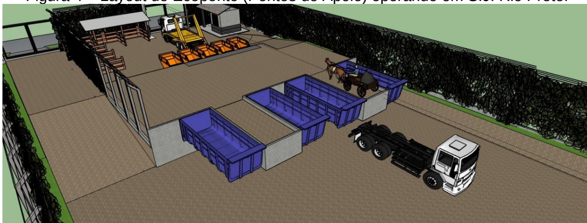
Figura 4 – Layout de Ecoponto (Pontos de Apoio) operando em S.J. Rio Preto.
