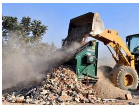
Foto 10 – Operação de separação granulométrica de RCC para uso imediato.
