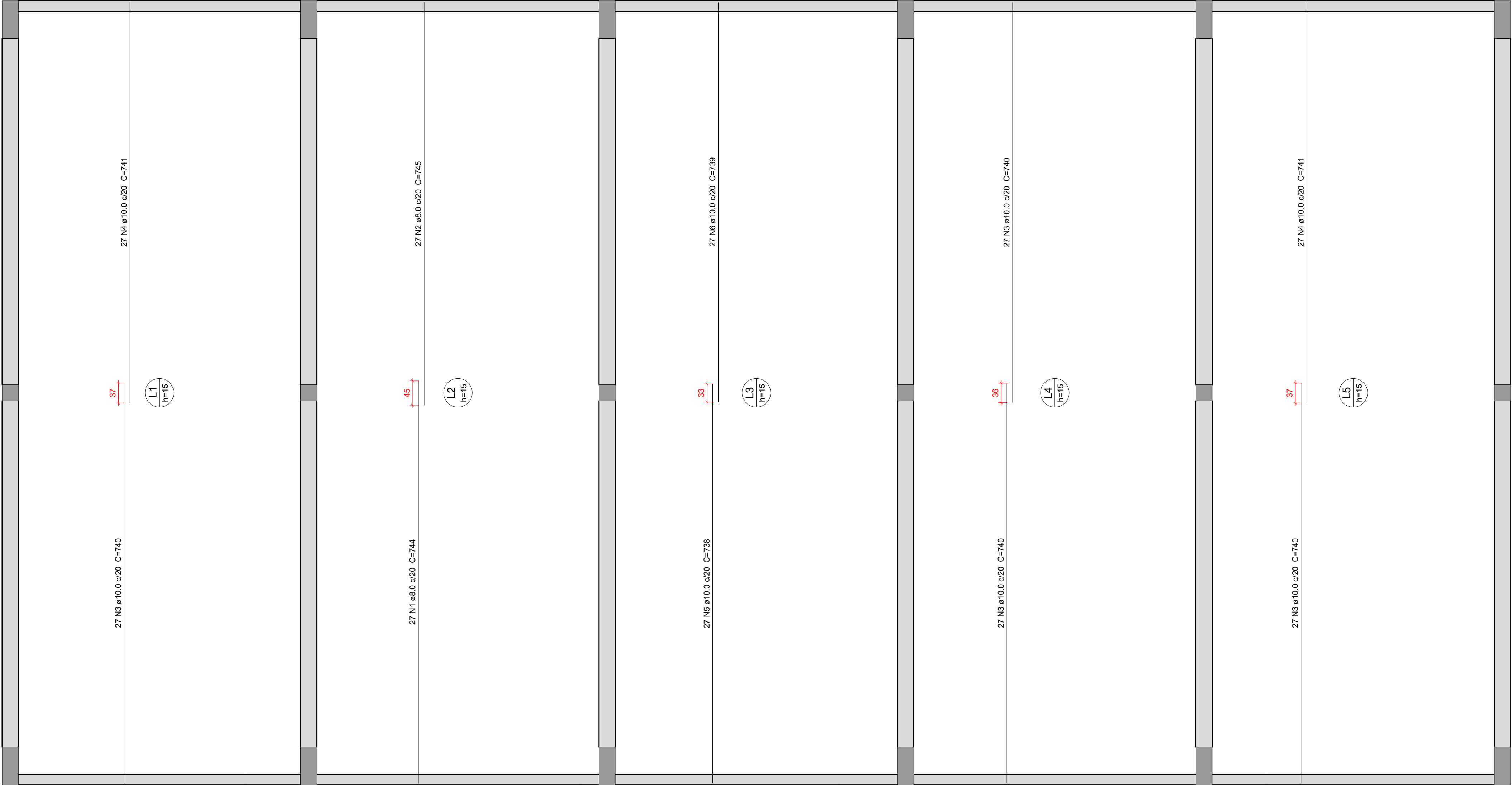
Armação positiva das lajes do pavimento TÉRREO (Eixo X)
